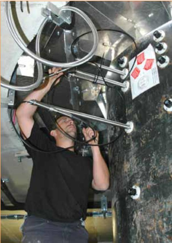
Photo 2. Dans les entrailles d'un macrocosme. Ici il s'agit de l'enceinte en métal contenant le monolithe de sol. Sur cette photo nous voyons un expérimentateur mettre en place des tensiomètres. Les tensiomètres permettent de mesurer la force de succion des racines pompant l'eau du sol (photo Jacques Roy).
